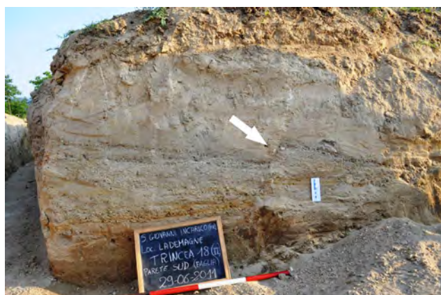
Fig. 6. I sedimenti della parete sud della trincea 18 (II) dislocati da una faglia distensiva immergente verso est, sintetica della faglia rinvenuta nella trincea 18 "Ampliamento" e avente rigetto analogo (indicato dalla freccia).
