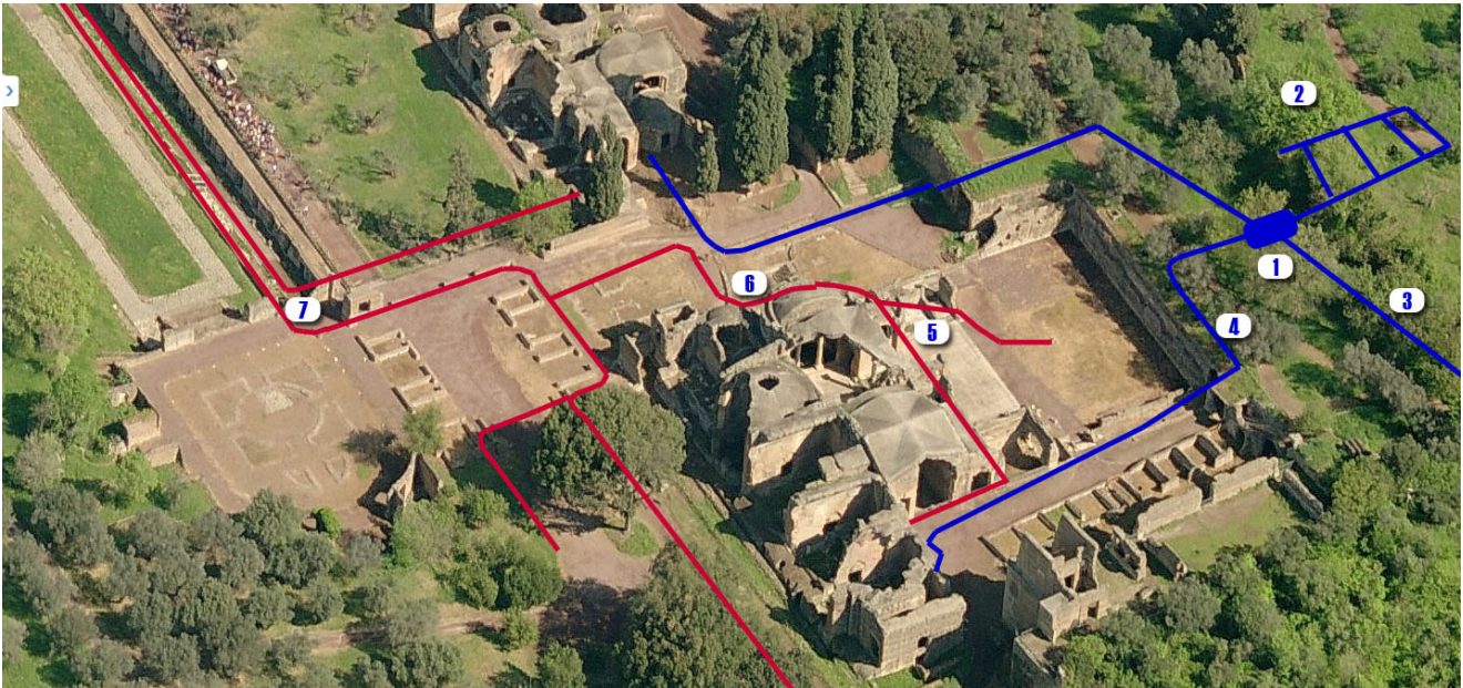
Fig. 1. L'area d'indagine con indicazione del percorso dei sistemi di adduzione (blu) e di scarico (rosso) delle Piccole e Grandi Terme: 1. sistema di adduzione, che comprende una serie di elementi, posizionato in corrispondenza del punto d'intercettazione del condotto di adduzione con il by-pass di collegamento con la cisterna repubblicana; 2. cisterna repubblicana riutilizzata in età adrianea; 3. condotto principale di adduzione idrica con andamento sud-nord; 4. ipotesi del percorso del condotto di adduzione delle Grandi Terme; 5. condotti di scarico delle Grandi Terme; 6. condotto di scarico delle latrine delle Grandi Terme; 7. immissione del condotto di scarico delle Grandi Terme e del Canopo al di sotto della strada basolata delle Cento Camerelle, in parallelo al condotto di scarico delle Piccole Terme.
